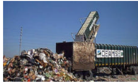
Fig. 6 – Cobertura provisoria con film biodegradable. Fig. 7 – Descarga tradicional por placa expulsora (trailer al frente) y descarga con Tipper (trailer al fondo).
