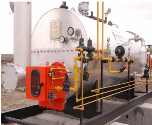
Calentadores Indirectos de Gas de 500.000 y 1 MM BTU/h: Empresa Prema Cía. del Sur
